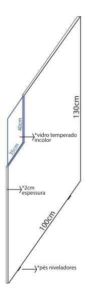
01 divisória incluindo a fixação em parede/chão, nas medidas de 230cm de largura x 180cm de altura x 3,5cm de espessura. A divisória deverá conter uma parte em MDF cor carvalho prata medindo 230cm de largura x 130cm de altura x 3,5cm de espessura e uma parte em vidro temperado incolor medindo 230cm de largura x 50cm de altura x mínima espessura segura, que deverá ser fixado no MDF.
