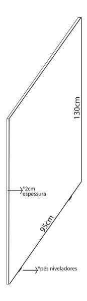
05 divisórias incluindo a fixação entre mesas. Devem ser confeccionada em material MDF cor carvalho prata nas medidas de 100cm de largura x 130cm de altura x 2cm de espessura. As divisórias deverão conter um recorte em "L" e instalação de vidro temperado incolor medindo 35cm de largura x 40cm de altura x mínima espessura segura, para identificação de guichês. Incluir dois pés niveladores de metal.
