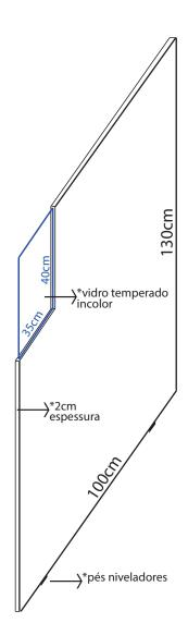
01 divisória incluindo a fixação em parede/chão, nas medidas de 270cm de largura x 180cm de altura x 3,5cm de espessura. A divisória deverá conter uma parte em MDF cor carvalho prata medindo 270cm de largura x 130cm de altura x 3,5cm de espessura e uma parte em vidro temperado incolor medindo 270cm de largura x 50cm de altura x mínima espessura segura, que deverá ser fixado no MDF.
